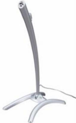
Pour la mesure du temps de propagation du son avec le microphone S ( 524059 ) ou à raccorder au compteur numérique ( 57548 ).
