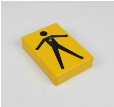
Pour des expériences sur la sécurité électrique. Silhouette noire sur socle en plastique jaune ; avec douilles aux mains et aux pieds ainsi que voyant incorporé qui s'allume dès qu'une tension est appliquée entre deux douilles quelconques.
