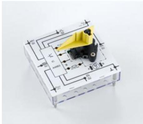
Le composant STE comprend un moteur pas à pas hybride, bipolaire à deux phases, en version à griffes, y compris l'électronique de commande.
