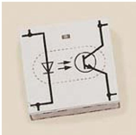
Élément enfichable pour la réalisation d'expériences permettant d'étudier le fonctionnement et l'utilisation d'une barrière lumineuse.
