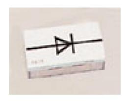
Diode au germanium pour le redressement de signaux de haute fréquence et la démodulation dans le circuit récepteur.
