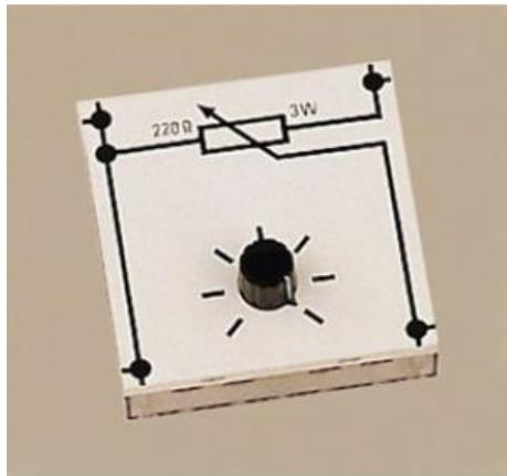
Réglage linéaire par bouton rotatif à index et échelle, utilisable comme résistance variable, diviseur de tension et générateur de tension alternative.
