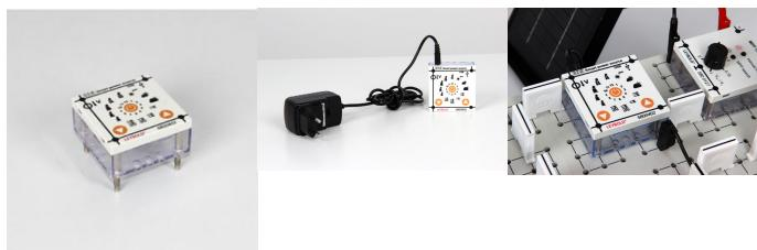
Unité STE Smart Power Source est une alimentation électrique et une source de tension contrôlée par microcontrôleur avec des profils prédéfinis.
