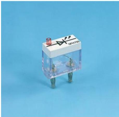
Diode émettrice de forme spéciale pour l'insertion de la fibre optique ( 57944 ). La lentille intégrée et la mise au point prédéfinie par la forme permettent une puissance de couplage élevée avec la fibre optique.
