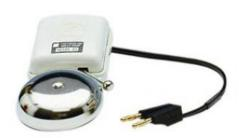
Pour étudier l'interruption de la propagation du son dans le vide (pression inférieure à 1 mbar). Avec câbles et connecteurs pour le branchement à l'alimentation électrique.
