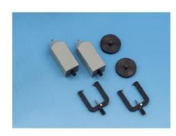
Pour réaliser un électro-aimant à l'aide des éléments du transformateur démontable afin d'obtenir des champs magnétiques homogènes ou non homogènes dans un espace réduit.
