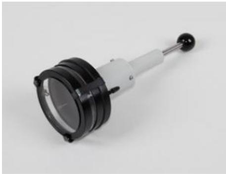
Pour visualiser les trajectoires de particules à ; brève durée de condensation du mélange alcool/vapeur d'eau dont la sursaturation par détente adiabatique est obtenue au moyen d'une pompe à air manuelle ; couvercle avec fenêtres en verre acrylique pour l'observation et le passage de la lumière ; douilles de raccordement pour tension de drainage servant à désioniser et support pour préparation de radium ( 559596 ).
