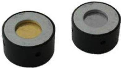
Feuille d'or et feuille d'aluminium pour expériences sur les pertes d'énergie des rayons alpha dans la matière. Feuilles dans support à placer sur le détecteur semi-conducteur 559921 , par ex. dans la chambre de spectroscopie 559565 Avec trous de ventilation latéraux.
