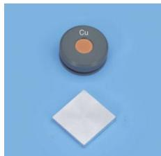
Pour l'appareil à rayons X (554 801) pour l'étude de l'effet Compton par transmission en fonction de la longueur d'onde, suivant le positionnement du filtre Cu devant ou derrière le diffuseur en aluminium avec corps dispersant en aluminium et filtre en cuivre dans monture.
