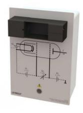
Support pour tube de Franck-Hertz au néon monté sur
