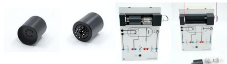
Adaptateur pour insérer un tube néon Franck-Hertz 555 8701 (au lieu de 555 870) dans un support 555 871. L'adaptateur n'établit que la connexion mécanique/électrique.
