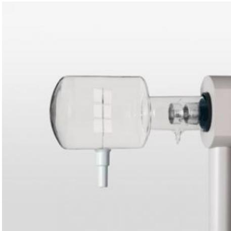
Pour la démonstration de l'excitation de l'émission de la lumière pendant et après un bombardement par électrons ou par rayonnement UV.
