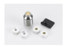
Collimateur avec diaphragme perforé et cristaux pour créer des clichés numériques de Laue avec le capteur pour radiographie (554 828) dans l'appareil de base à rayons X (554 800).
