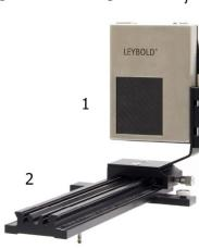
Capteur d'image compacte à haute résolution avec connexion Ethernet pour la prise directe de radiographies dans un appareil à rayons X sous des conditions d'éclairage naturel (sans film radiographique ou écran luminescent).
