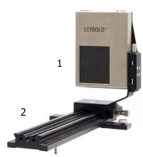
Capteur d'image compacte à haute résolution avec connexion Ethernet pour la prise directe de radiographies dans un appareil à rayons X sous des conditions d'éclairage naturel (sans film radiographique ou écran luminescent).
