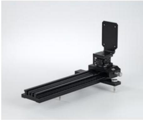
Pour le positionnement et l'ajustage précis du capteur pour radiographie ( 554828 ) dans l'appareil à rayons X ( 554800 ou 55481 ).
