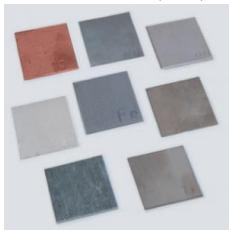
Utilisées avec le détecteur d'énergie de rayonnement X ( 559 938 ), le Sensor-CASSY ( 524 013 ) et l'adaptateur AMC ( 524 058 ), les cibles permettent de relever les spectres de fluorescence X de différents éléments dans l'appareil à rayons X ( 559 801 ).
