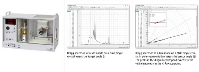
Appareil complet commandé par microprocesseur avec tube de Mo et goniomètre pour la réalisation de nombreuses expériences du domaine de la physique des rayons X.
