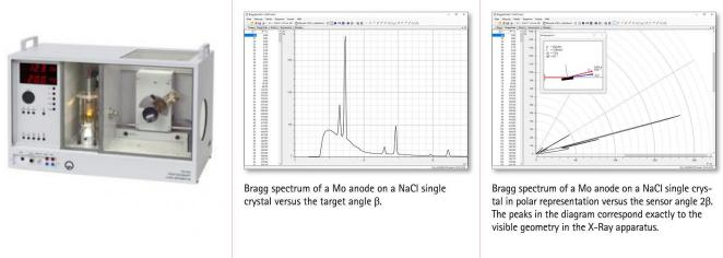
Appareil complet commandé par microprocesseur avec tube de Mo et goniomètre pour la réalisation de nombreuses expériences du domaine de la physique des rayons X.
