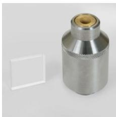
Utilisé avec le détecteur dénergie de rayonnement X ( 559 938 ) et l'appareil à rayons X ( 554 801 ), permet détudier leffet Compton sur les rayons X.
