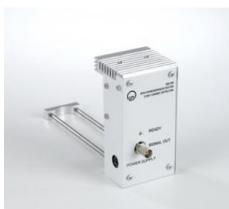
S'utilise dans l'appareil à rayons X ( 554 801 ) et en association avec le Sensor-CASSY ( 524 013 ) et l'adaptateur AMC ( 524 058 ) pour le relevé de spectres de rayons X résolus en énergie.
