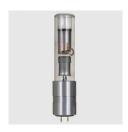
Tube à cathode chaude incandescente à chauffage direct avec filetage pour composant de refroidissement et culot à broches bipolaire pour le chauffage de la cathode ; convient pour l?appareil à rayons X (554 800 / 554 801)
