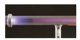
Pour observer les éclairs lumineux produits par les décharges électriques dans les gaz raréfiés en fonction de la pression ainsi que pour étudier les rayons cathodiques et canaux qui surviennent à basse pression (= 3x10 -2 mbar) hors du trajet de décharge et au-delà des électrodes en aluminium percées. Les calottes d'extrémité du tube à décharge sont recouvertes de matériau fluorescent.
