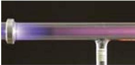
Pour observer les éclairs lumineux produits par les décharges électriques dans les gaz raréfiés en fonction de la pression ainsi que pour étudier les rayons cathodiques et canaux qui surviennent à basse pression (=  $3 \times 10^{-2}$  mbar) hors du trajet de décharge et au-delà des électrodes en aluminium percées.
