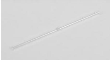
Pour produire des charges par frottement et mettre en évidence les forces d'attraction et de répulsion qui s'exercent entre les charges électriques.
