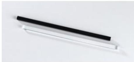
Pour produire des charges par frottement et mettre en évidence les forces d'attraction et de répulsion qui s'exercent entre les charges électriques.
