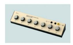
7 décades en boîtier pupitre, réglage par commutateurs rotatifs à 11 positions.
