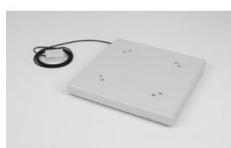
Plaque stable permettant de mesurer les forces exercées lorsque les élèves sautent dessus.
