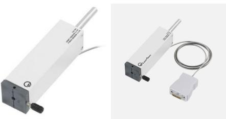
Pour mesurer des forces (par ex. électrostatiques) de ±1N avec CASSY ( 524013 , 524006 , 524005W , 524018 ) ou l'instrument de mesure universel Physique ( 531835 ). Avec deux lames souples à quatre jauge extensométriques montées en pont.
