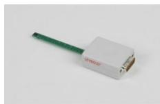
Pour la mesure de la densité du flux magnétique de petits champs en direction axiale avec CASSY ( 524013 , 524006 , 524005W , 524018 ) ou l'instrument de mesure universel Physique ( 531835 ). La sonde sert par exemple à mesurer la valeur et la direction du champ magnétique terrestre (40 ... 60 $\mu T$ ) ou à mesurer le champ magnétique d'un conducteur traversé par un courant continu ou alternatif (Biot et Savart).
