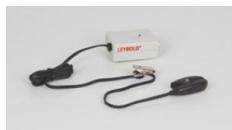
Pour mesurer la fréquence cardiaque à l'aide d'une cellule de mesure à infrarouge fixée au lobe de l'oreille ou au bout du doigt avec réglage automatique de la sensibilité à l'aide de CASSY. Chaque pulsation est signalée par une LED. Le capteur des pulsations est isolé galvaniquement de CASSY.
