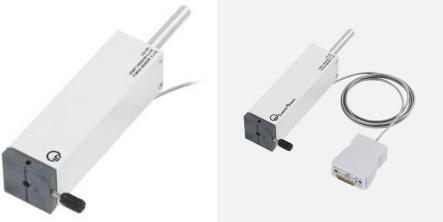
Pour mesurer des forces (par ex. électrostatiques) de ±1N avec CASSY ( 524013 , 524006 , 524005W , 524018 ) ou l'instrument de mesure universel Physique ( 531835 ). Avec deux lames souples à quatre jauge extensométriques montées en pont.
