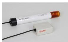
Associé à CASSY ( 524013 , 524006 , 524005W , 524018 ) ou à l'instrument de mesure universel de Chimie ( 531836 ) et aux réactifs appropriés ( 6662600 , 6662601 , 6662603 , 6662604 ), le photomètre à immersion S permet de mesurer les polluants et la turbidité dans des échantillons d'eau.
