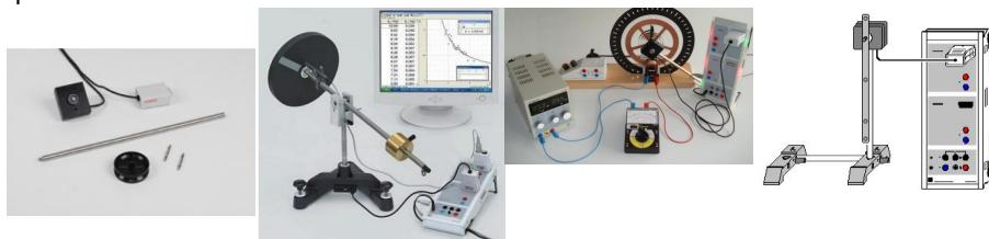
Pour la mesure sans frottement de mouvements de rotation, de déplacements linéaires, d'amplitudes, de périodes et de fréquences de rotation avec le Sensor-CASSY ( 524013 ), le Pocket-CASSY ( 524006 , 524018 ) ou l'Instrument de mesure universel Physique ( 531835 ).
