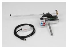
Pour étudier la force radiale d'un corps tournant avec CASSY ( 524013 , 524018 , 524006 , 524005W ) ou l'instrument de mesure universel Physique ( 531835 ) en fonction de sa masse, du rayon de sa trajectoire et de sa vitesse angulaire.
