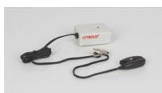
Pour mesurer la fréquence cardiaque à l'aide d'une cellule de mesure à infrarouge fixée au lobe de l'oreille ou au bout du doigt avec réglage automatique de la sensibilité à l'aide de CASSY. Chaque pulsation est signalée par une LED. Le capteur des pulsations est isolé galvaniquement de CASSY.
