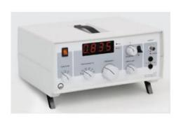
Générateur de signaux sinusoïdaux, triangulaires et carrés, avec amplificateur de puissance intégré : 5W (sinus), 10W (carré), fréquences de 0,1Hz à 100kHz, affichage numérique de la fréquence.
