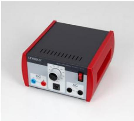
Alimentation pour les expériences simples en électricité et en électronique. Tension de sortie réglable par paliers ; protégée contre les surcharges par des coupe-circuits automatiques. Toutes les sorties sont isolées galvaniquement du réseau, sans mise à la terre. Convient très bien pour les travaux pratiques avec des élèves de tous âges grâce à l'isolement sécurisé conformément à la réglementation BG/GUV-SI 8040.
