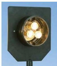
Pour les expériences sur le mélange additif des couleurs sur un banc d'optique. Trois ampoules branchées en parallèle dans carter avec écran monté sur tige pour fixation sur cavalier (460 95ET5). L'interrupteur à bascule intégré permet d'éteindre une des ampoules.
