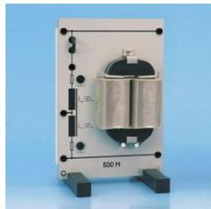
Pour des expériences sur l'induction et l'auto-induction ainsi qu'avec le condensateur 40  $\mu$ F (517021) pour la réalisation d'un circuit oscillant avec une fréquence de 1Hz. Schéma fonctionnel sérigraphié sur la plaque d'expérimentation.
