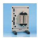
Pour des expériences sur l'induction et l'auto-induction ainsi qu'avec le condensateur 40  $\mu$ F (517021) pour la réalisation d'un circuit oscillant avec une fréquence de 1Hz. Schéma fonctionnel sérigraphié sur la plaque d'expérimentation.
