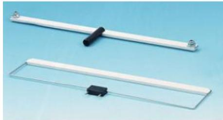
Utilisé avec la balance électrodynamique ( 51632 ) et le support à hauteur variable ( 51631 ), ce matériel permet de mesurer la force exercée entre deux conducteurs parcourus par un courant variable suivant leur écartement et l'intensité du courant qui les traverse.
