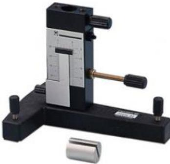
Pour la mesure et le réglage exact de l'écartement d'objets placés face à face en position verticale, par ex. dans des expériences avec la balance électrodynamique ( 51632 ) utilisée avec les accessoires ( 51637 ) ou avec les boucles conductrices ( 51633 ) pour la définition de l'ampère selon la théorie de l'électrodynamique.
