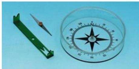
Modèle illustrant le fonctionnement d'une boussole directrice ; convient également pour la projection.
