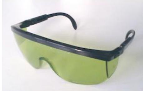
Lunettes de protection laser, absorbent la lumière de pompage de 808 nm, le rayonnement laser Nd:YAG de 1064 nm. Filtre vert avec ~56% de transmission de la lumière du jour.
