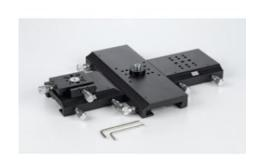
Pour relier en croix trois ou quatre bancs d'optique, par ex. pour l'interféromètre de Michelson. Un support pour séparateur de faisceau peut être monté au centre, un plateau à déplacement est prévu sur un bras.
