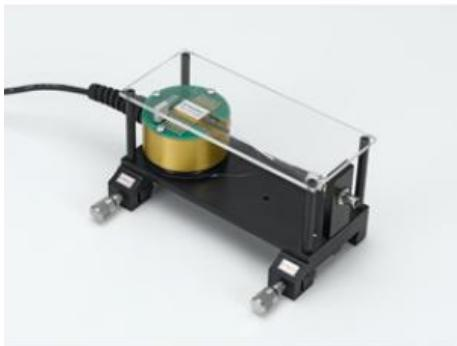
**Laser de pompe pour fibres dopées erbium, avec connecteur ST monomode.**
