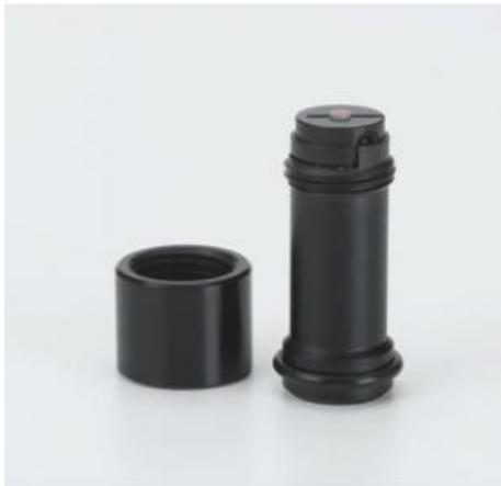
Barreau de Nd:YAG dont une face est recouverte d'une couche réfléchissante à 1064 nm et qui est transparente pour la lumière de pompage à 808 nm.
