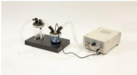
Produit une brume composée de gouttelettes extrêmement fines. L'alimentation génère un flux d'air réglable et alimente le nébuliseur dans un bain-marie. Un deuxième récipient permet l'élimination des grosses gouttes d'eau de façon à ce que seulement les fines gouttelettes parviennent à la sortie.
