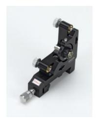
Collimateur pour fibre avec connecteur ST, gauche
