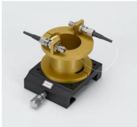
Ce module est la pièce maîtresse de l'installation et l'un des composants les plus précieux. Il se compose d'une fibre dopée à l'erbium de 4 m, enroulée sur un tambour. Les extrémités de la fibre sont reliées à des connecteurs ST qui sont eux-mêmes reliés à la prise de fibre.
