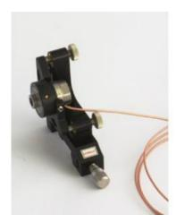
Élément piézoélectrique dans support ajustable
