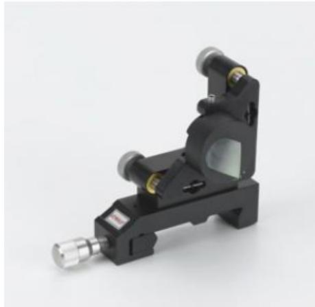
Un prisme de Littrow à surface arrière fortement réfléchissante (> 99,9 %) pour accorder le laser hélium-néon sur une raie orange (612 nm).
