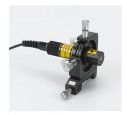
Laser à diode dans support ajustable
