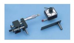
Avec vis micrométrique pour un déplacement précis du miroir plan (473 461). Pour la détermination en interférométrie de la longueur d'onde du faisceau laser. Sur tige.
