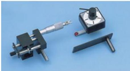
Avec vis micrométrique pour un déplacement précis du miroir plan ( 473 461 ).
