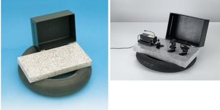
Pour le montage de différents dispositifs à interféromètres et pour la réalisation d'hologrammes de réflexion à lumière blanche et d'hologrammes de transmission.
