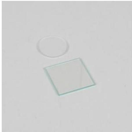
Plaque en verre à faces planes et parallèles et lentille plan-convexe. Pour l'observation et l'étude quantitative des anneaux de Newton en transmission et en réflexion. Des anneaux sont créés en pressant la lentille et la plaque de verre l'une contre l'autre. Fixation au support pour diaphragmes et diapositives ( 45933 ).
